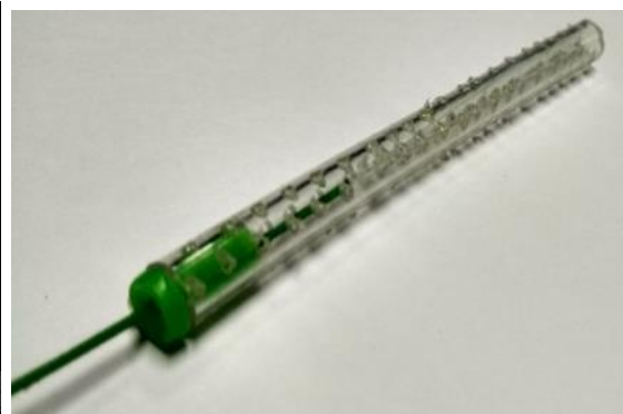
Fig. 1: Sensores de humedad y su caracterización (a y b) desarrollados en la Universidad Pública de Navarra utilizando fibras ópticas microestructuradas.
